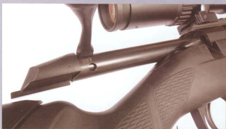
Uusi juttu on lukon pinnoittaminen teflonilla, jolloin se on kiiltelemätön, liukas ja hiljainen.
