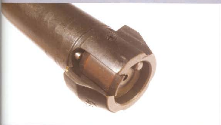
Perinteisen pulttilukkoisen tavoin Tikassa on kaksi lukitusolkaa, mutta niiden kartiokas muoto on laitettu uusiksi. Ulosvetimen kynsi on leveä ja jousikuormitettu tappi pukkaa hylsyet voimalla ulos.
