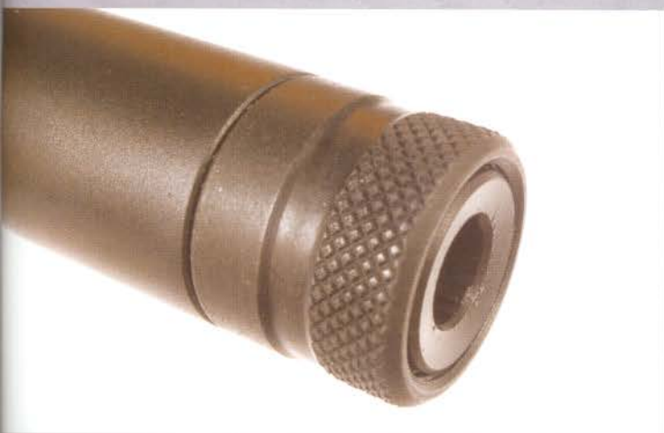
Piipun suulla on siistillä suojaholkilla peitetty 5/8x24 kierre vaimentimelle. Tämä on mainio asia, sillä näin kierre on valmistettu jo piipun suun yhteydessä ja todennäköisimmin täysin suorassa.
